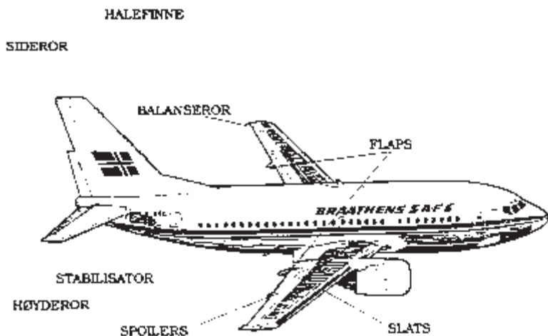
Figur 4. Figuren viser de viktigste rorene på et fly
